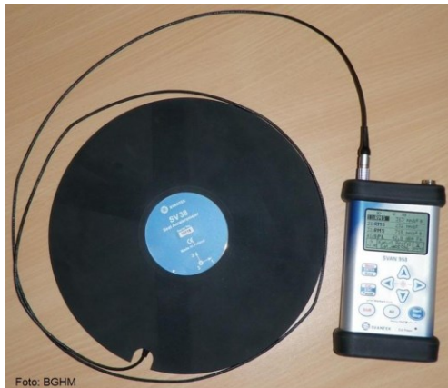
Schwingungsmessgerät zur zeitgleichen mehrkanaligen Aufzeichnung
