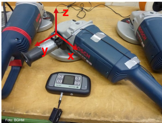
Triaxial-Schwingungsaufnehmer am Nebengriff eines Winkelschleifers
